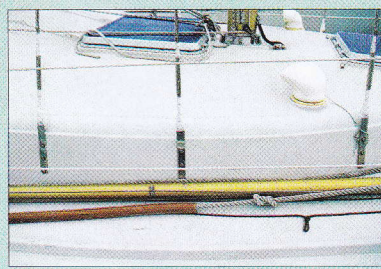
Les trois cadènes fixées sur le roof permettent de rentrer le génois.
